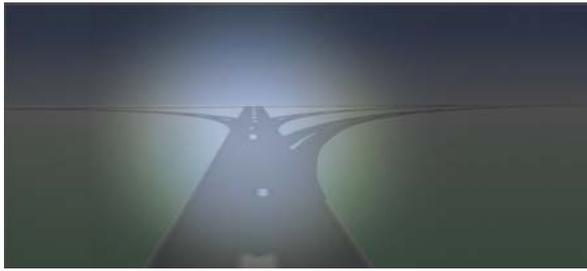
Une grande portion de la lumière projetée sur la route est gaspillée avec des systèmes optiques traditionnels, car la forme du faisceau est symétrique.
